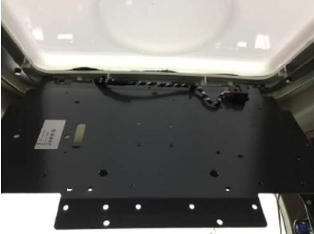
2. Entfernen Sie die Halterung für die Antennenmontage. Setzen Sie den Spurführungscontroller genau auf die Mitte der Halterung.
