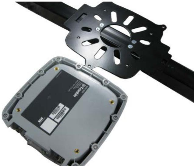
4. Setzen Sie die Befestigungsplatte mit dem Holm darauf. Bringen Sie die Platte mit den vier 6-mm-Schrauben und den Federringen am Spurführungscontroller an. Ziehen Sie die Schrauben an. Achten Sie darauf, sie nicht zu fest anzuziehen, um Schäden zu vermeiden.
