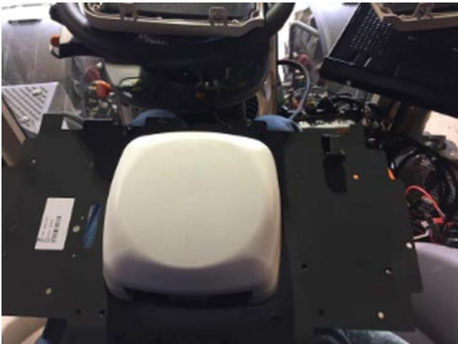
3. Markieren Sie mit der Befestigungsplatte als Vorlage die Positionen, und bohren Sie dort Löcher mit einem Durchmesser von 0,64 cm zur Montage des Spurführungscontrollers.
