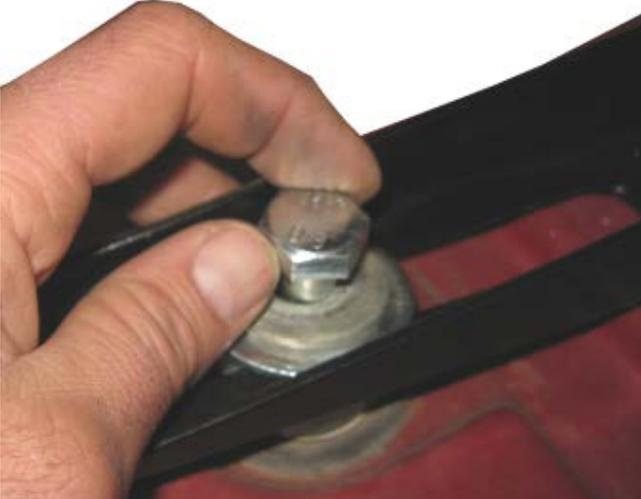
9. Bringen Sie die zweite Schraube wie beschrieben auf der anderen Seite der Kabine an. Zentrieren Sie den Holm mit einem Maßband auf der Kabine. Ziehen Sie die Schrauben fest.
