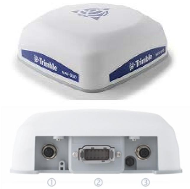
An der Rückseite befinden sich drei Anschlüsse:
