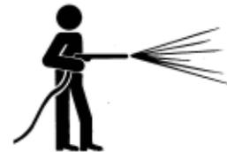
Stellen Sie den Schlauchdruck so gering wie möglich ein und spritzen Sie in einem Winkel von 45° bis 90°. Halten Sie mit der Düse des Dampfstrahlers den vom Hersteller empfohlenen Abstand zu der Maschine ein.
