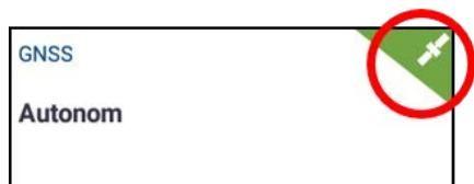
GNSS ist auf **autonome** Korrekturen voreingestellt. Berühren Sie das **GNSS**-Symbol in der oberen linken Ecke der Statusleiste, um eine Übersicht der gerade benutzten Spurführungskorrekturen zu sehen:
