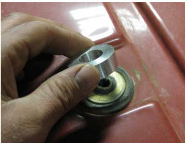
7. Nehmen Sie eine der mitgelieferten längeren Schrauben, die zur Befestigung des Holms dienen. Setzen Sie die ursprüngliche Unterlegscheibe und die mitgelieferte größere Unterlegscheibe auf die Schraube.
