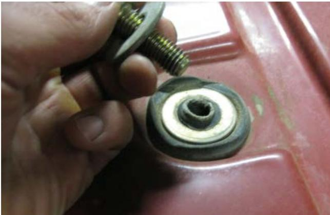
6. Setzen Sie das mitgelieferte Distanzstück auf den Montagepunkt auf der Kabine. Die Dicke des Distanzstücks hängt vom verwendeten Paket ab.
