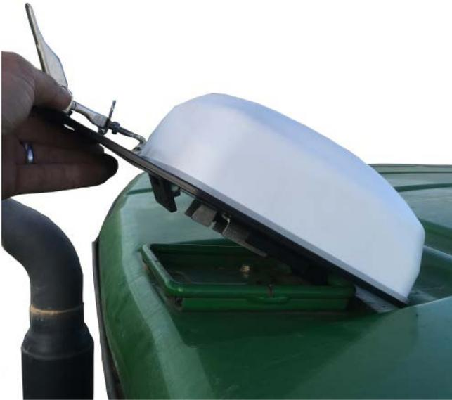
3. Senken Sie die Vorderseite ab, und befestigen Sie sie mit der Verriegelung.
