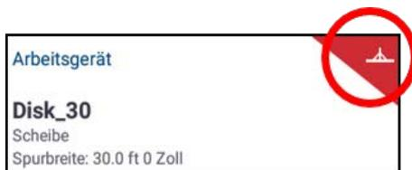
Sie **müssen** ein gültiges Arbeitsgerät wählen, bevor Sie ein Material oder eine Aufgabe auswählen können. Um ein Fahrzeugprofil zu ändern, berühren Sie die Kachel **Arbeitsgerät** und wählen Sie ein anderes Arbeitsgerät vom Bildschirm. Drücken Sie **Arbeitsgerät auswählen**:
